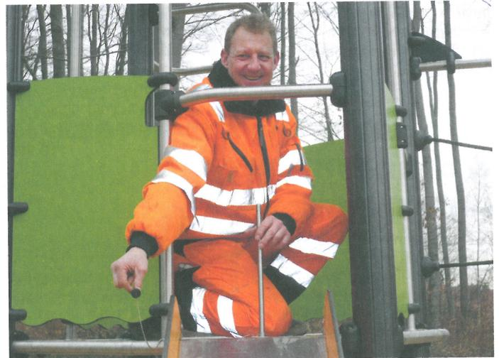
Jürgen Wellenbrock testet mit einem speziellen DIN-Prüfkörper Gerätebereiche auf sogenannte „Kordelfangstellen“, die kleinen Anorakträgern zum Verhängnis werden könnten.
